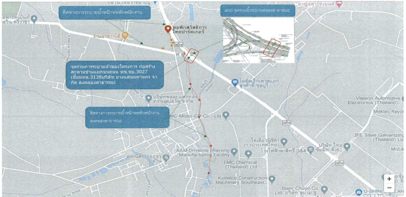
รูปภาพที่ 11 แผนที่ทิศทางการระบายน้ำจากโครงการก่อสร้างสะพานข้ามแยกบนถนนทช.ชบ. 3027 เชื่อม ทล.3138 บริษัท บางแสนมหานคร จำกัด ลงคลองสาธารณะ ภาพจาก Google
